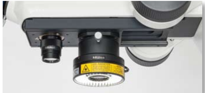
滑動式鏡頭交換座裝設1個物鏡和環狀LED照明時
